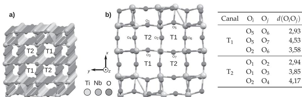
FIGURE 20 – a) Représentation tridimensionnelle des canaux de  $TiNb_2O_7$  dans lesquels le lithium peut s'insérer. b) Représentation des canaux selon l'axe  $Oz$  avec certains atomes d'oxygène indiqués. Tous ces atomes sont dans le même plan et les distances interatomiques sont données dans le tableau. Ce dernier donne quelques distances entre atomes d'oxygène représentés en b), exprimées en Å.
