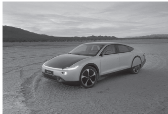
Figure 10 La société néerlandaise Lightyear propose une berline équipée de 5\text{ m}^2 de panneaux solaires qui mesure 5,05\text{ m} de longueur, 1,82\text{ m} de largeur et 1,40\text{ m} de hauteur et possède un coefficient de traînée C_x = 0,23
