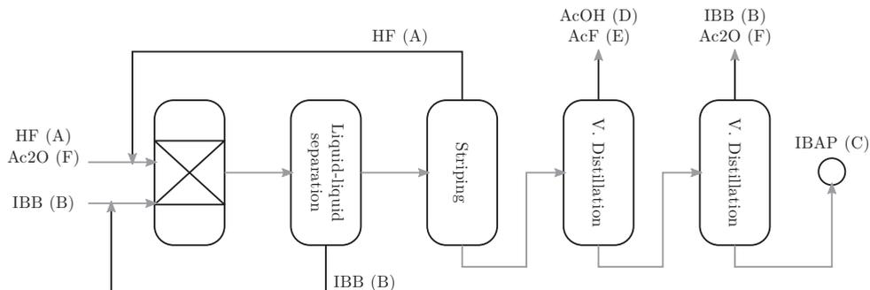
Figure 5 Schéma de principe du procédé BHC.
